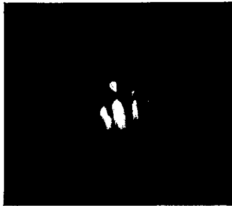
Fig. 10. Bild der Emissionsfläche einer parallel geritzten kalten Kathode, Gitterabstand 0,8 mm; Vergrößerung 15 fach; Beschleunigungsspannung 65 kV (vergoldeter Glasleuchtschirm).
